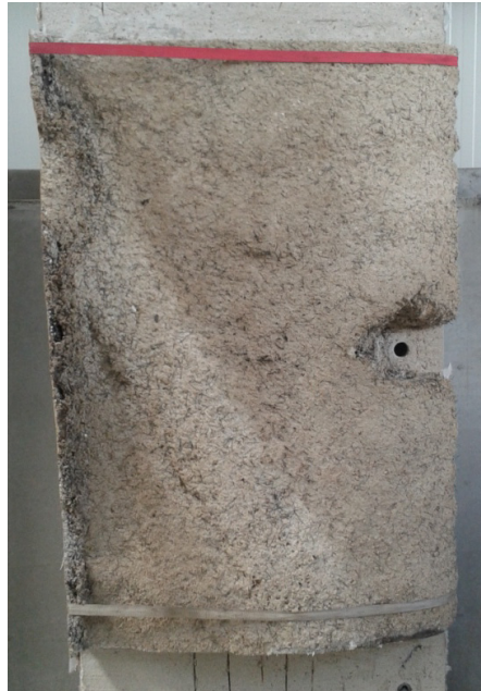
Bild 9: Prüfkörper nach Beanspruchung durch einen Brand gemäß der EBA-Brandkurve
