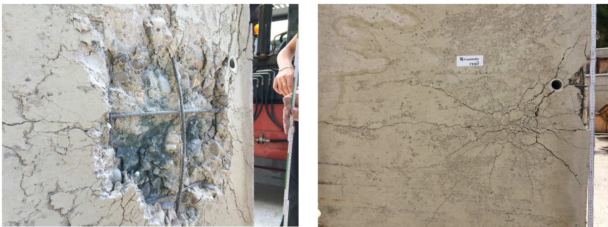
Bild 10: Rückseite der Betonunterkonstruktion ohne Schutzcoating (links) und mit Schutzcoating (rechts)
