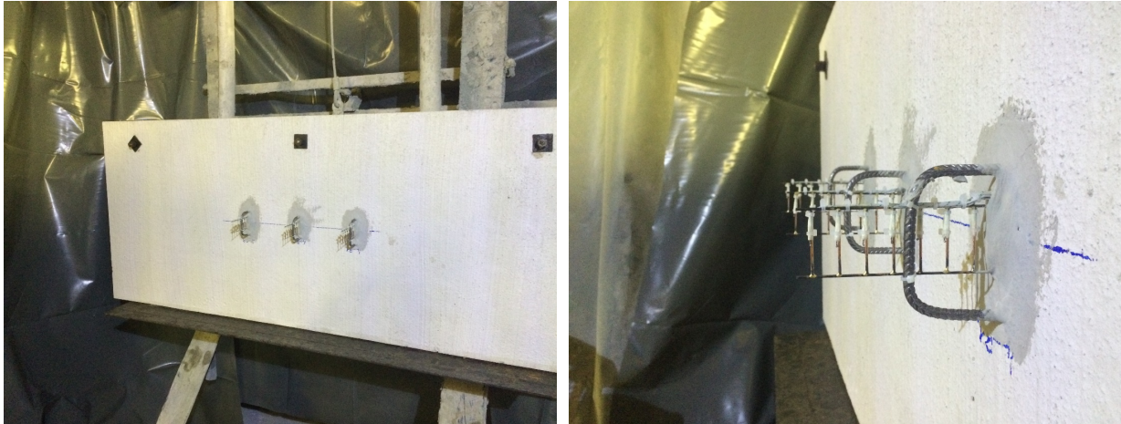
Bild 8: Unterkonstruktion des Prüfkörpers (links) und Großaufnahme der im Weiteren eingespritzten Temperaturfühler (rechts)
